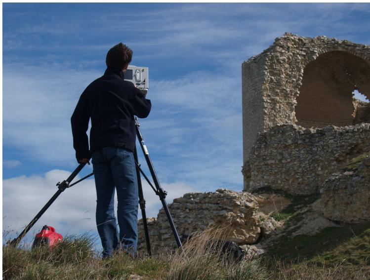
**Figura 1:** *Recolha de dados com o scanner laser 3D*
