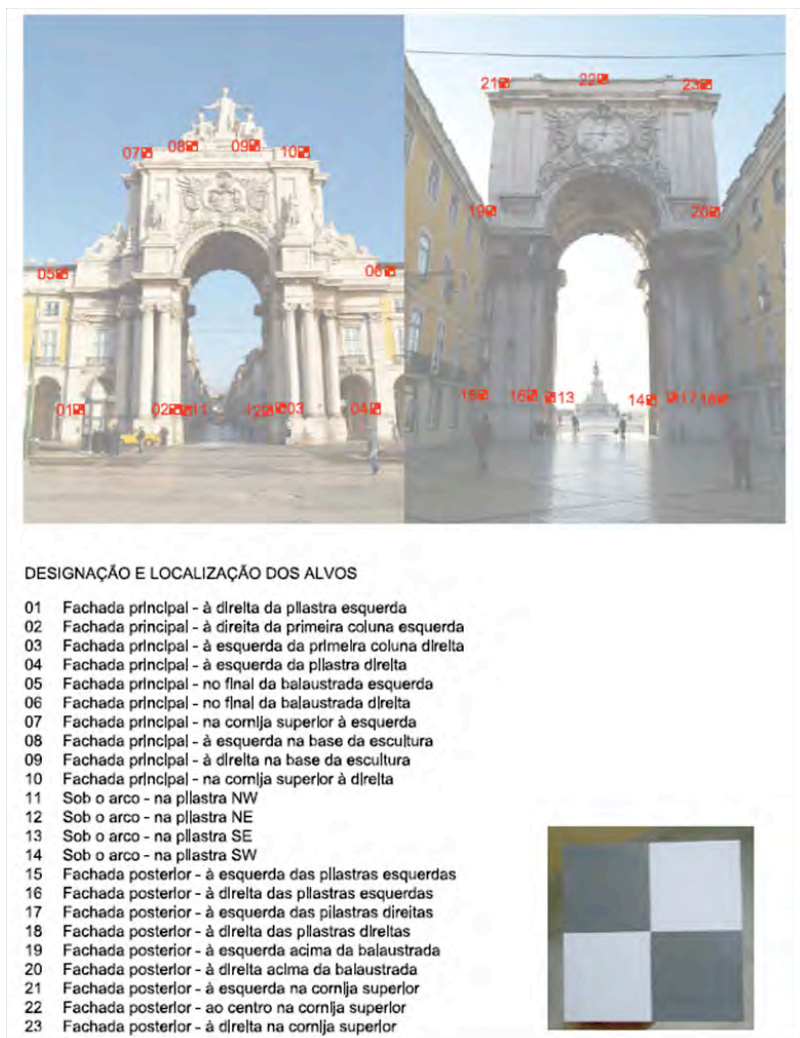
Fig. 4.22: I dodici target apposti sull'Arco da Rua Augusta – pianificazione.
