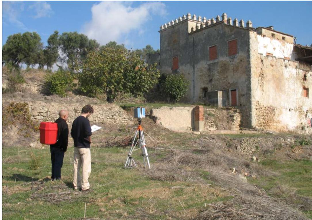
Levantamento por sistema de varrimento laser 3D
