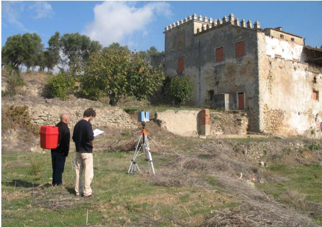
Levantamento por sistema de varrimento laser 3D
